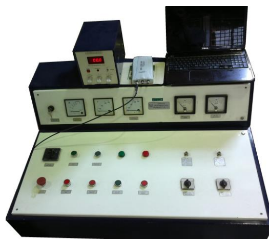
شکل ۶: مجموعه میز کنترل ولتاژ به همراه پیک ولت‌متر، کارت آنالوگ به دیجیتال و رایانه مورد استفاده در آزمایشگاه تخلیه جزئی
