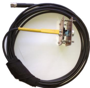
شکل ۵: سنسور فراصوت ۴۰R SSQC-SQ همراه یک کابل کواکسیال ۵۰
